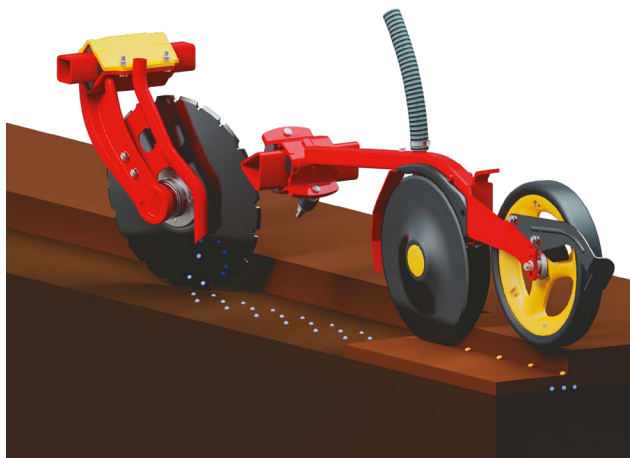
Система Fix закладывает удобрения в полосы шириной 5 см с междурядьем 12,5 см перед каждым рядом семян.
