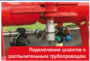
Подключение шлангов к распылительным трубопроводам
