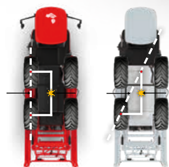
Шасси StabiloPlus очень устойчиво благодаря большому расстоянию от центра тяжести до опорной линии.
