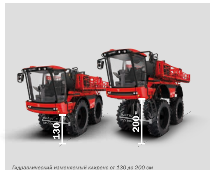
Гидравлический изменяемый клиренс от 130 до 200 см
